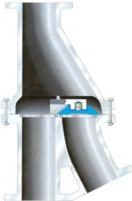
**ТРЕХСТОРОННИЙ, ОТВОДЯЩИЙ ИЛИ СХОДЯЩИЙСЯ.** Этот клапан показан в литой конфигурации, подходящей для давления 300 фунтов на кв. дюйм (PN50). Доступна сборная версия для более высоких давлений и температур.
